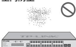
灰尘落在交换机表面会造成静电吸附, 使金属接点接触不良。虽然设备本身在防静电方面做了一定措施, 但当静电超过一定强度时, 仍会对内部电路板上的电子元器件造成致命的破坏, 为避免静电影响设备正常工作, 请注意以下事项:
